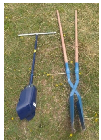
Palas extractoras de tierra
